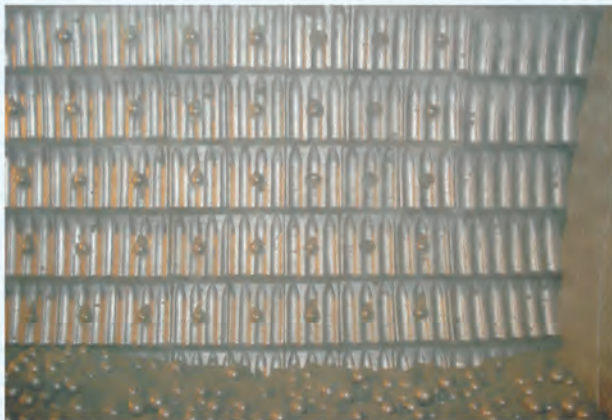
Φ5×15m水泥磨沟槽衬板使用1.5年后形貌 Grooved liner appearance after 1.5 years in Φ5×15m
